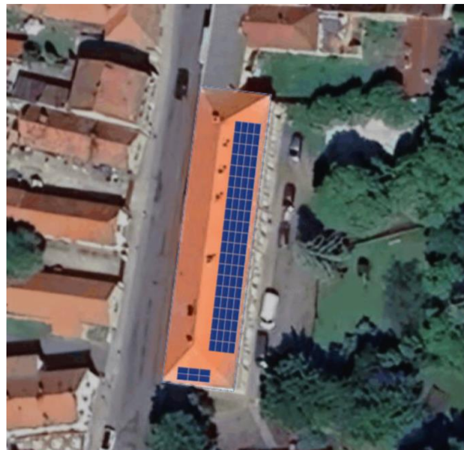
Obrázek 84 Model FVE na střeše budovy bývalých stájí-lékař
